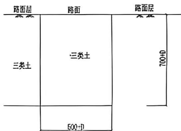
DN50管原土路面沟槽开挖断面图
