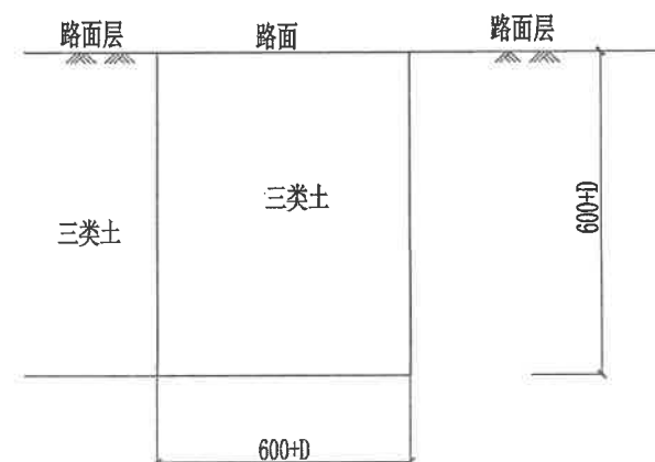
DN100管原土路面沟槽开挖断面图
