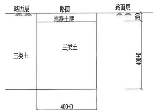
DN80、DN50管混凝土路面沟槽开挖断面图
