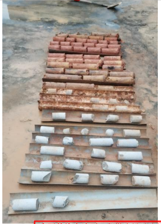
项目名称:南宁市江南区中心粮食储备库工程 钻孔编号:22 深度(m):20.3 描述员:刘志勇 勘察单位:南宁市勘测设计院集团有限公司 拍摄时间:2023-03-31 11:20:41 钻孔类型:技术孔 项目负责人:韦炫思 编录员:李新晴
