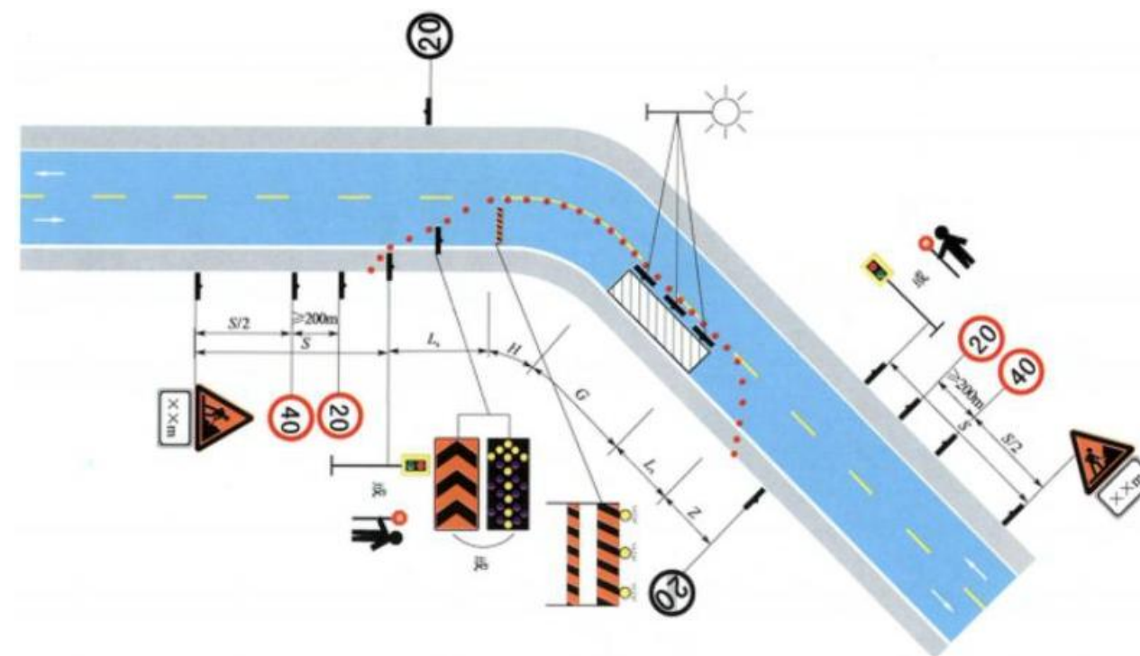
图2.3.2.1-3 弯道后路段临时养护作业示意图
