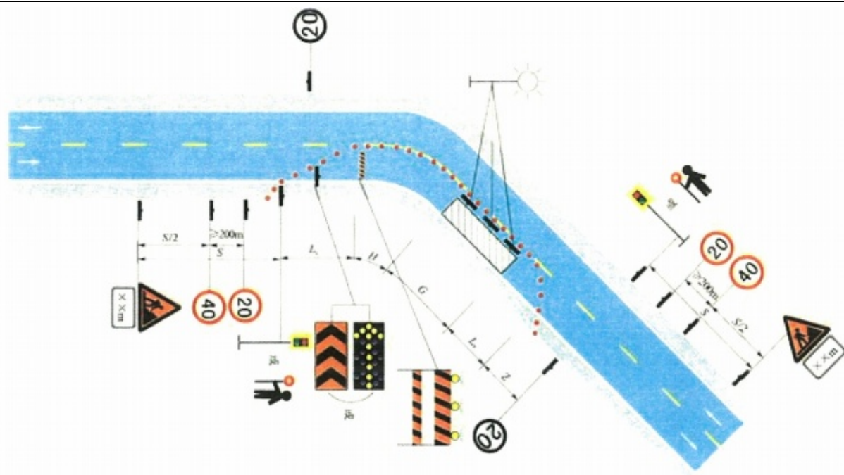
(三) 弯道后路段临时养护作业示意图
