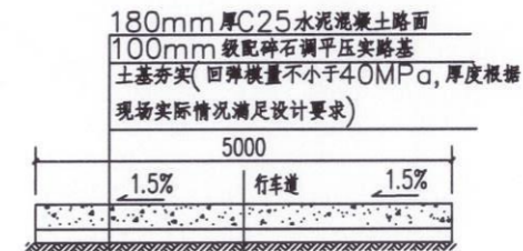
道路结构横断面图 1:50 注:凿除旧路面重建,道路总面积150平方米
