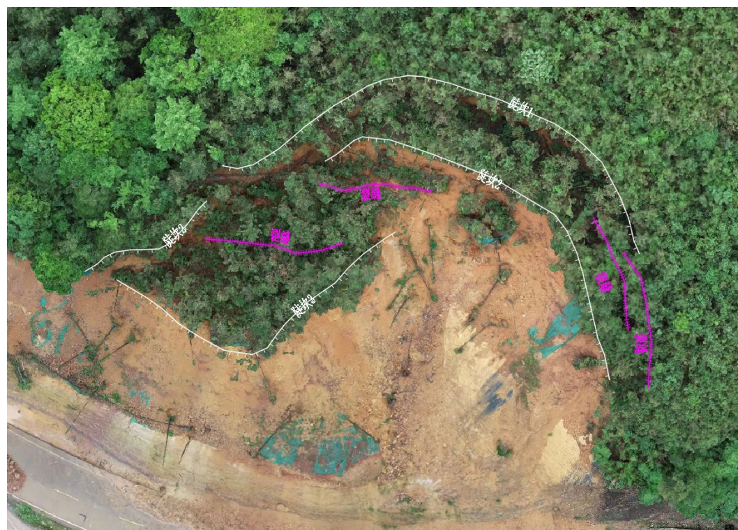
图 4-2 滑坡体陡坎及裂缝发育特征
