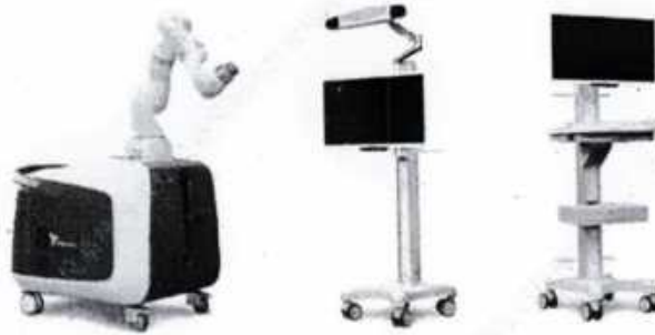
图2.1 机械推车,光学定位台车,导航控制手车
